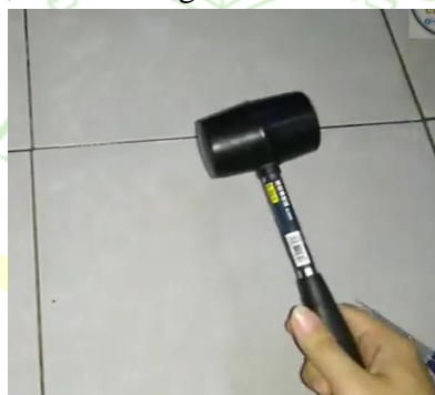
Gambar 11 Palu karet dan pemukulan pasangan keramik dinding
