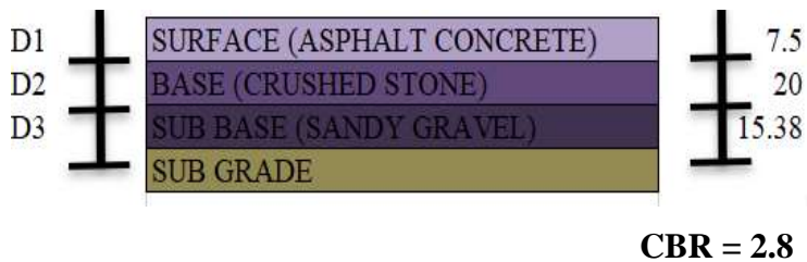
Gambar 4.8 Lapisan Perkerasan dari Banjarbaru masuk Bandara dan ke Banjarmasin
